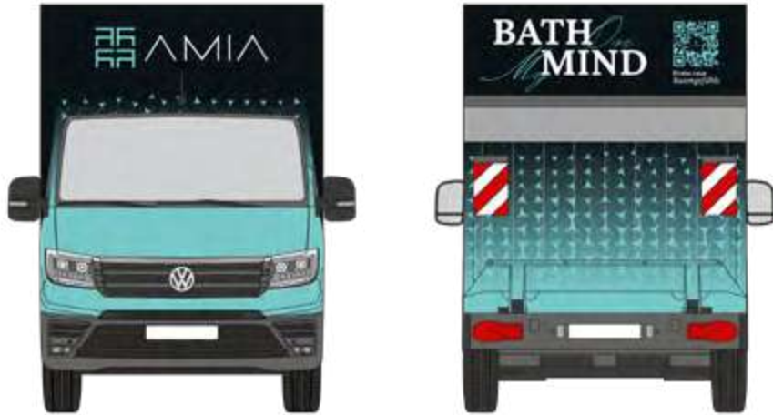
VW Crafter Fahrgestell mit Beispielaufbau, Radstand mittellang (2017) 1:30 L: 6.130 B: 2.040 H: 2.943 R: 3.640
